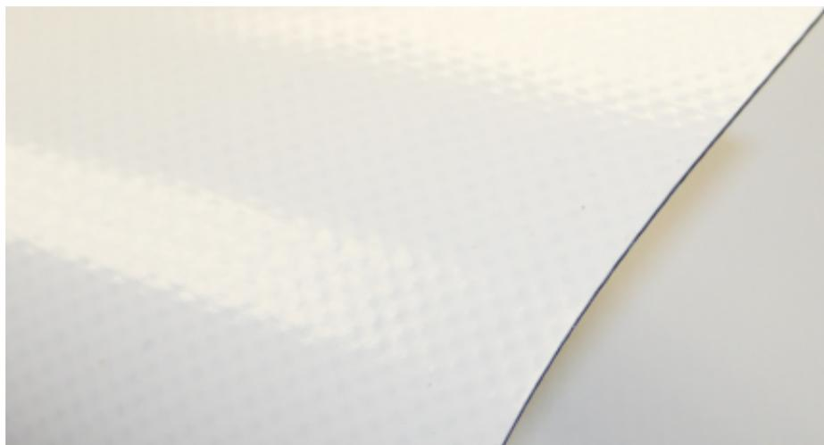
Hochfestes Polyestergewebe, beidseitig in Blockout Technologie ausgeführt, mit Weich-PVC beschichtet. Die Membrane ist fungizid ausgerüstet, beidseitig lackiert und schwer brennbar klassifiziert nach EN 13501-1. Die Oberfläche ist hochglänzend ausgeführt.
