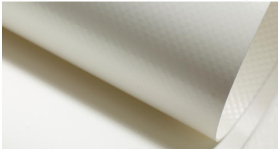
Tejido base de poliéster Anti-Wicking de alta tenacidad, recubierto por ambas caras con PVC blando, con alta estabilidad UV. La membrana tiene acabado fungicida y está clasificado como difícilmente inflamable bajo la norma EN 13501-1. Superficie con acabado brillante por ambas caras.
