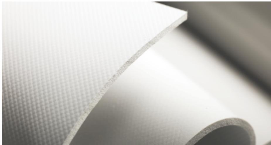
Polyplan Thermofoam es una membrana difícilmente inflamable, dotada de biocidas y espumada por una cara. La espuma ofrece tanto aislamiento térmico como acústico y está compuesta por celdas cerradas, evitando así cualquier absorción de agua. De este modo Polyplan Thermofoam es ideal como membrana para carpas, puertas enrollables y pérgolas.
