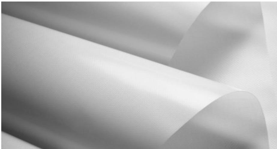
Les Membranes hautement translucides seront mises en place partout où les pièces auront besoin d'être protégées mais pas trop assombries. Un tissu de base résistant confère à la membrane la solidité et la stabilité nécessaires et une enduction PVC transparente et résistante aux intempéries permet une transmission de la lumière suffisante. Un tissu de base hautement résistant avec une enduction PVC translucide et un vernis haute brillance avec une transmission à la lumière optimisée.
