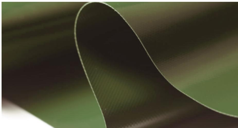
Tissu polyester hautement résistant, ignifuge sur les 2 faces, enduction PVC souple et laqué. Face supérieure mate
