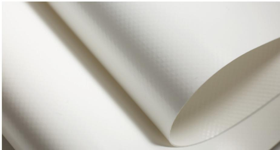
Tessuto in poliestere estremamente resistente, spalmato in PVC morbido su entrambi i lati con finissaggio finale, difficilmente infiammabile secondo DIN 75200.
